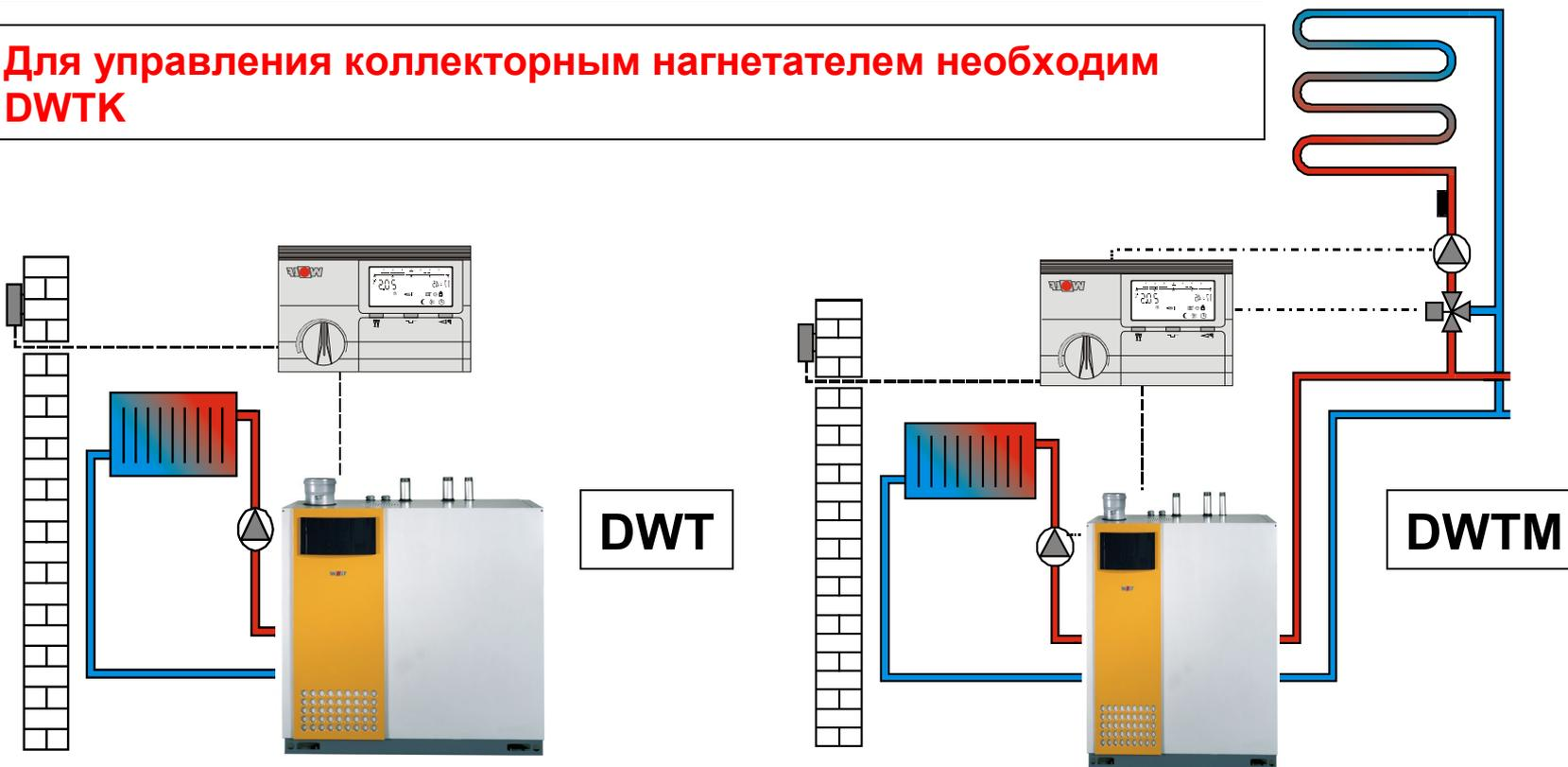
Наименьший проток необходим только при температуре в трубопроводе  $> 85\text{ }^{\circ}\text{C}$
