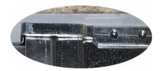
Крючок сзади гарантирует простое скрепление накопительного и нагревательного узлов
