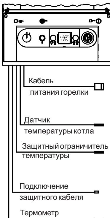
При монтаже устройства регулирования проследить за тем, чтобы не повредить капилляры датчиков!
