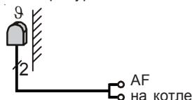
Соединить кабель датчика наружной температуры, обеспечиваемого на месте, со штекером подключения, входящим в комплект поставки устройства регулирования. Подключить штекер к соответствующему разъему на клеммной колодке устройства регулирования котла и закрепить кабель зажимом. Провести кабель через отверстие в обшивке котла. Закрепить датчик наружной температуры на северной или северо-восточной стене здания на высоте 2 - 2,5 м над землей. (Кабель прокладывается вертикально вниз).
